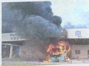
图 4-1-26 过充电导致的温度过高着火
